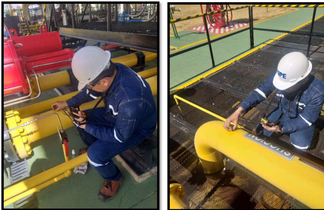
Figura 8. Medición de espesor a descarga y succión
